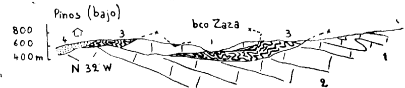
Fig. 9.—Profil par le massif d'Isbor. 1, Trias calcaire, 2, Trias dolomitique. 3, Schistes cristallins de la nappe de Guajar. 4, Molasse helvétique.
