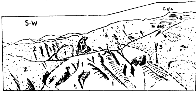
Fig. 20. — Le flanc sud de l'anticlinal de l'Almijara, vu du Cerro del Sol. Schistes et quartzites paléozoïques (1) pincés entre le Trias dolomitique de l'écaïlle del Sol (2) et le Trias calcaire du flanc sud de l'anticlinal de l'Almijara (3).
